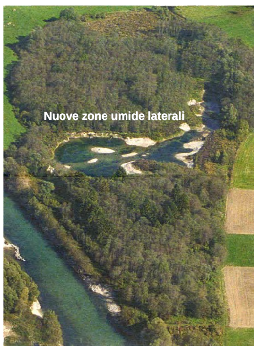
Figura 5.12 – Fiume Drava (Austria). Diversificazione morfologica di una piana inondabile, ottenuta mediante scavo del piano campagna allo scopo di creare una zona umida laterale.
