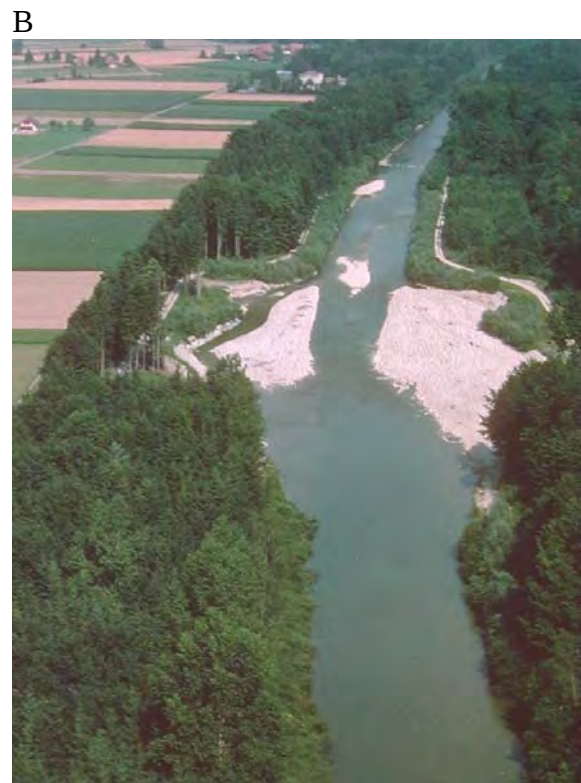
Figura 5.14 – Interventi di allargamento dell'alveo (da Habersack & Piégay, 2008). A) Incremento del numero di interventi in Austria e Svizzera (in ascisse sono riportati gli anni, in ordinate il numero di interventi realizzati). B) Esempio di intervento di allargamento lungo il Fiume Emme (Svizzera).
